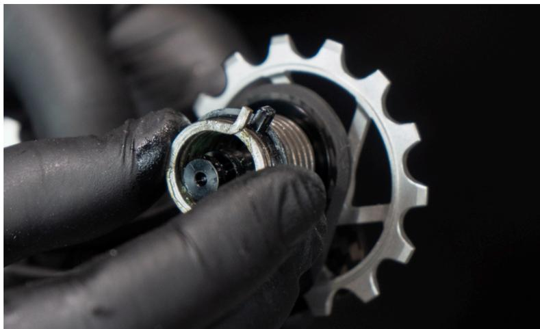
10. Place the Nova Ride derailleur cage into the derailleur and tighten the derailleur screw using the T10 Torx key.
