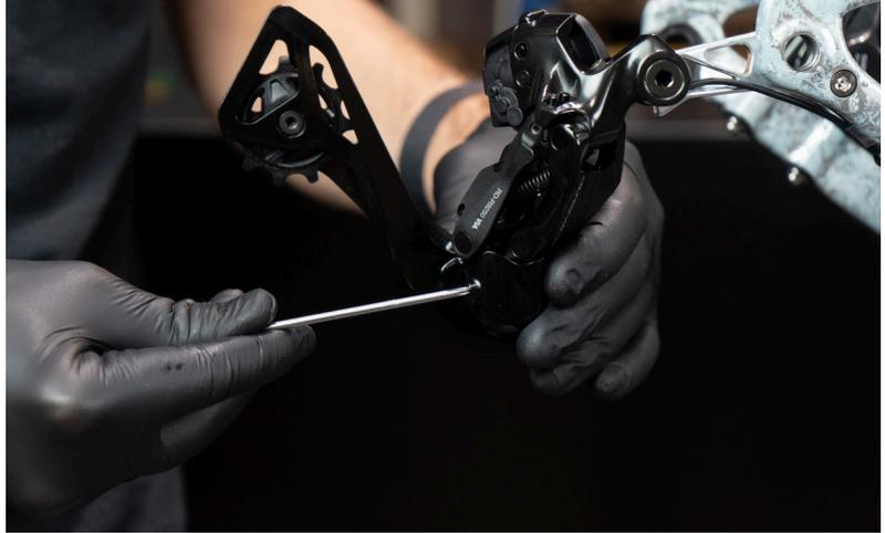
5. Rotate the original derailleur cage clockwise.
