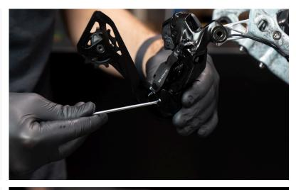
**5.** Rotate the original derailleur cage clockwise.
