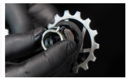
**10.** Place the Nova Ride derailleur cage into the derailleur and tighten the derailleur screw using the T10 Torx key.
